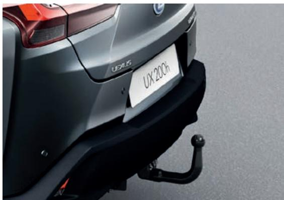
Vertikalna rastavljiva vučna kuka
